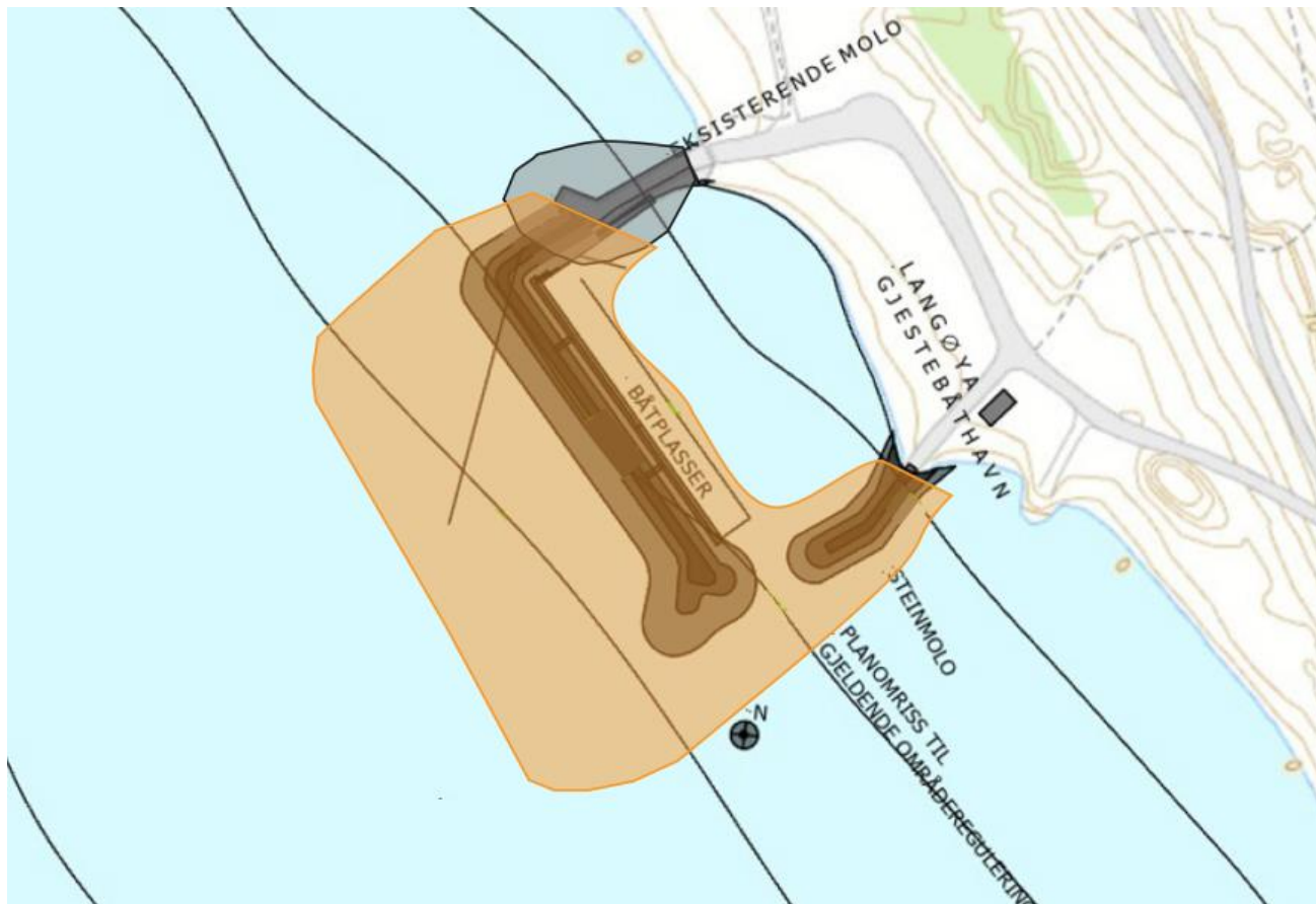
Figur 1 Planlagte tiltak med beregnet størrelse på fyllingsfot markert i brunt.
