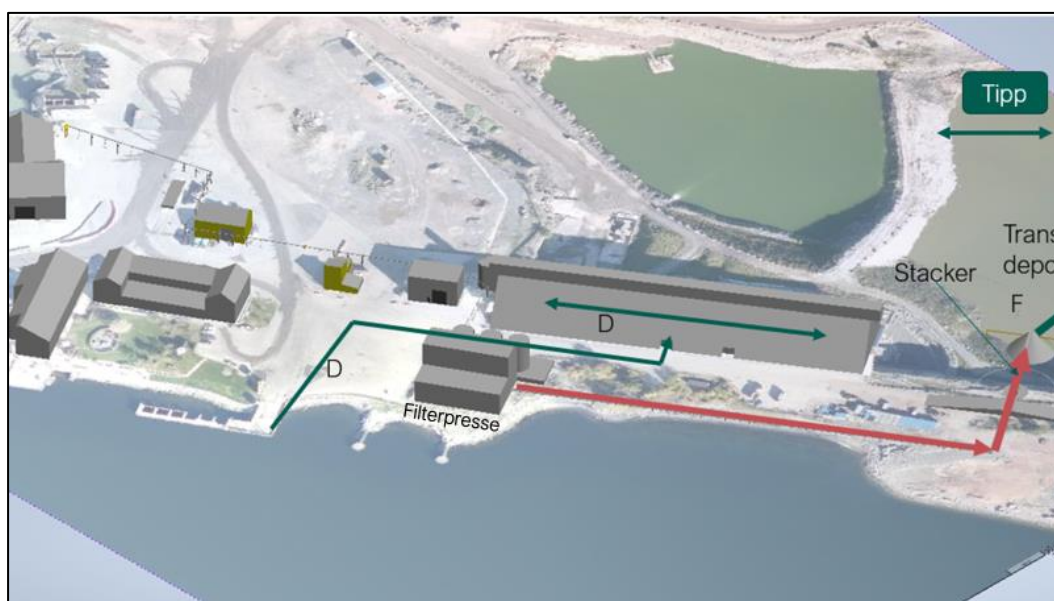
Figur 4.2: Illustrasjon av aktuell plassering av kammerfilterpresse (kan bli endret). Piler angir kun retning avfallsstrømmer, ikke posisjon transportutstyr. Trasé for transportbånd er ikke bestemt.
