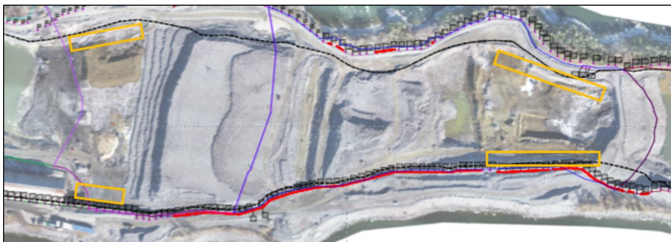
Figur 5.2: Ringdreneringen er etablert opp til løpende avfallshøyde i fire områder markert med oransje rektangler.
