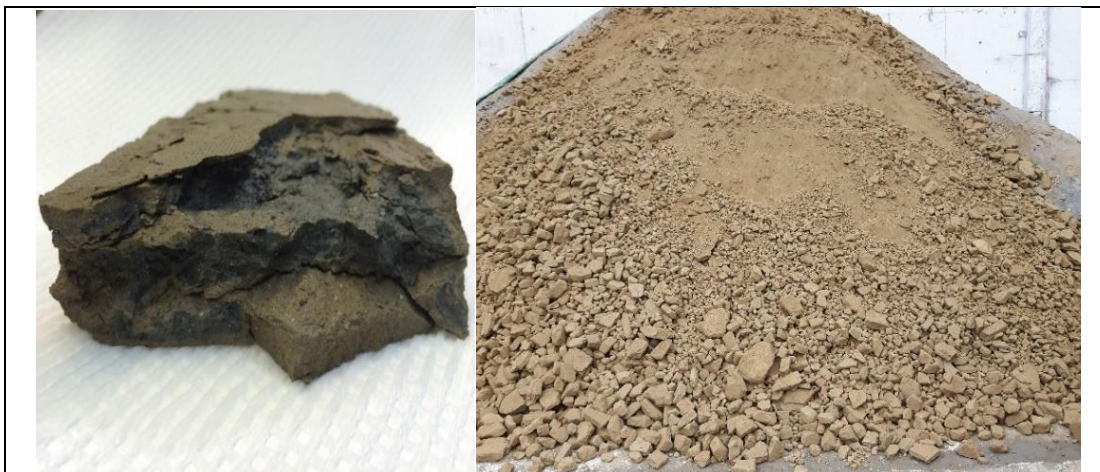
Figur 4-4: Stabilisert filterkake er tenkt deponert i gruen i Brevik. A) Filterkakebit fra testkjøring i desember 2014 (Foto: NGI) B) Filterkake fra testkjøring i 2018 (Foto: NOAH).
