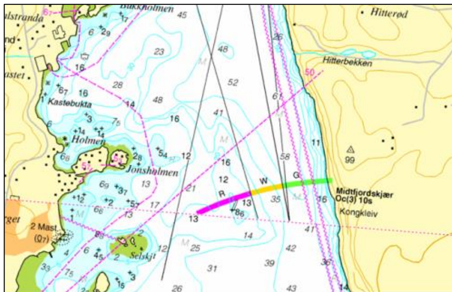
Figur 3-7: Utsnitt fra sjøkart, trasé for sjøkabel angitt mellom to streker med lilla farge langs fjellskråning i øst.
