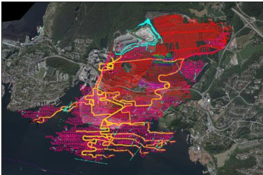
Figur 3-6: Illustrasjon av Dalen gruve. Gruven er markert med rødt. Driftsveiene under bakken med gult.
