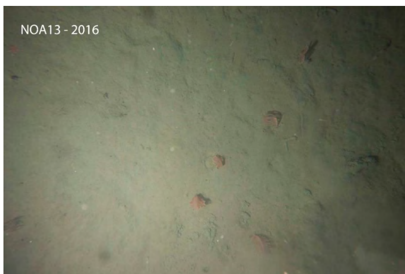
Figur 9. Overflatebilde fra SPI-riggen blir tatt rett ovenfra og ned på ca. 1-1,5m avstand fra bunnen. Ved hjelp av disse bildene kan man få et generelt inntrykk av hvor mange organismer det er av noen arter i området, i tillegg til spor, hull etc. På dette bildet ser man mange sjøfær.
